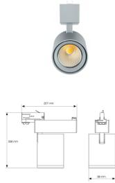
Caractéristiques Spot LED sur rail 3 phases
